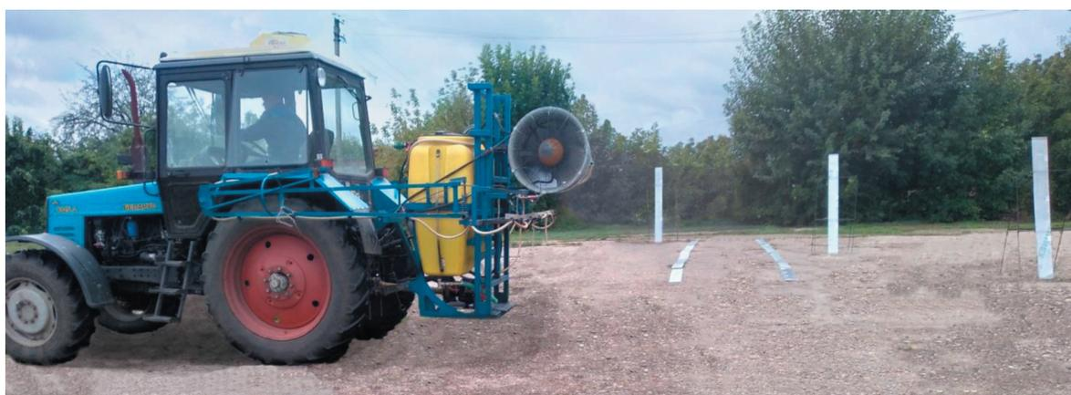
**Рис. 10.** Процесс нанесения капель на карточки из воздушно-капельного потока.
