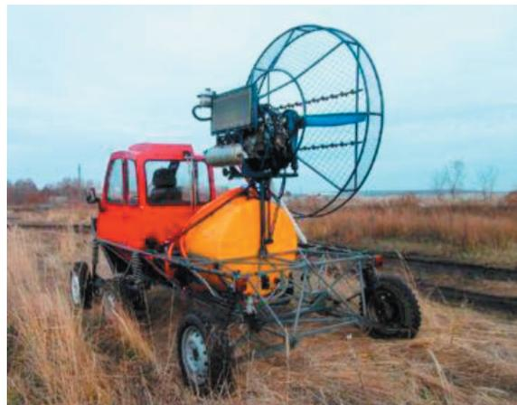
Рис. 4. Общий вид опрыскивателя “РОСА”.
