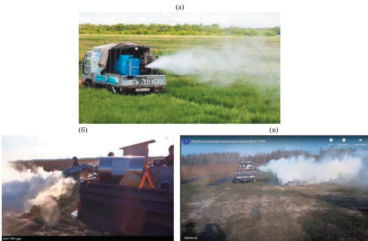
**Рис. 6.** Общий вид аэрозольной струи, создаваемой генераторами малой производительности, установленными в кузове автомобиля: (а) – газотермический генератор ГАРД – вид сзади слева, (б) – генератор холодного тумана Model 1200.
