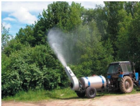
Рис. 3. Общий вид рабочего процесса опрыскивания лесополосы опрыскивателем центробежного принципа действия.
