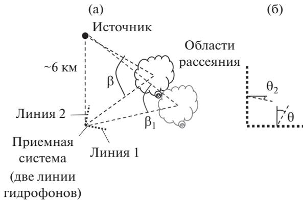
Рис. 1. (а) Геометрия эксперимента (вид сверху), (б) обозначение углов при фазировании антенны.
