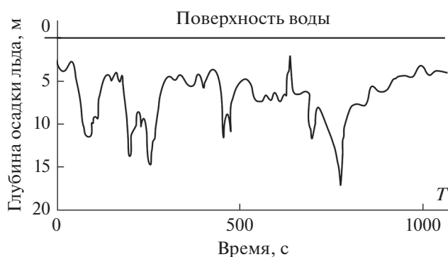
Рис. 2. Пример записи профиля нижней поверхности дрейфующего льда при цикличности измерения 1 с.
