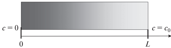
Рис. 1. Замедление скорости распространения волны на конечном интервале [L-0] до нулевого значения.
