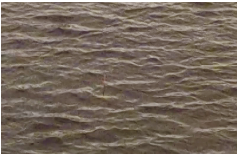
Рис. 2. Увеличенное изображение части поверхности рис. 1, полученное с видеокамеры № 2. В центре рисунка видно изображение “оптической” вешки, с использованием которой восстанавливается временная зависимость колебания поверхности в точке ее расположения.
