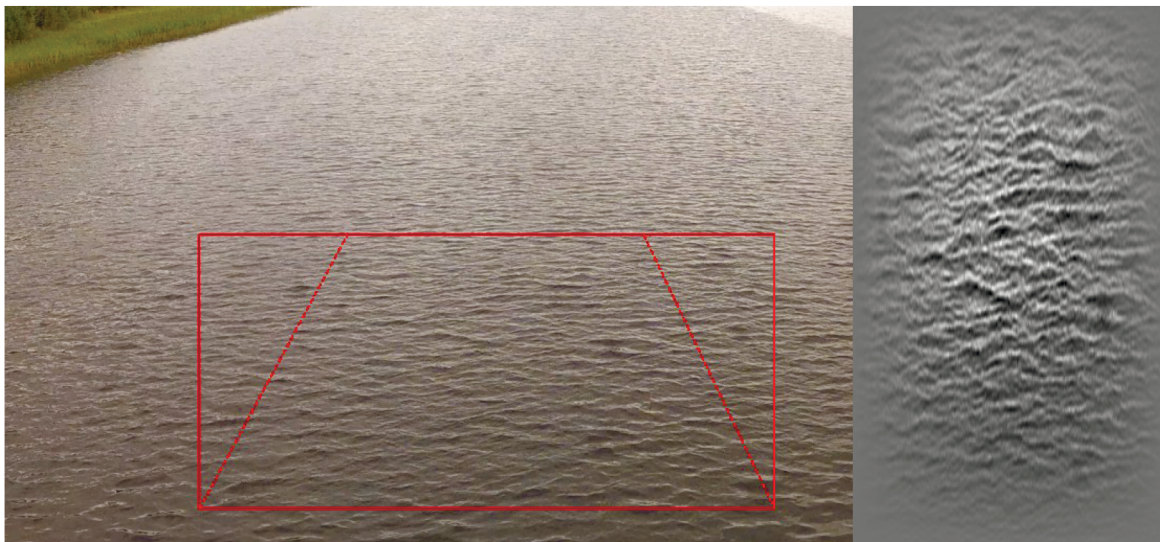
Рис. 1. Пример кадра видеозаписи с выделенной (трапеция) областью обработки. Справа — результат применения к выделенному трапецией участку поверхности алгоритма коррекции перспективы с наложением оконной функции Ханнинга.
