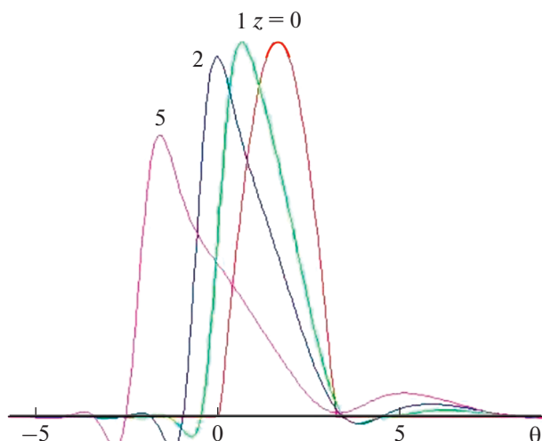
Рис. 2. Искажение формы положительного однополярного импульса в релаксирующей среде с ядром (6). Параметром кривых является пройденное волной расстояние z .
