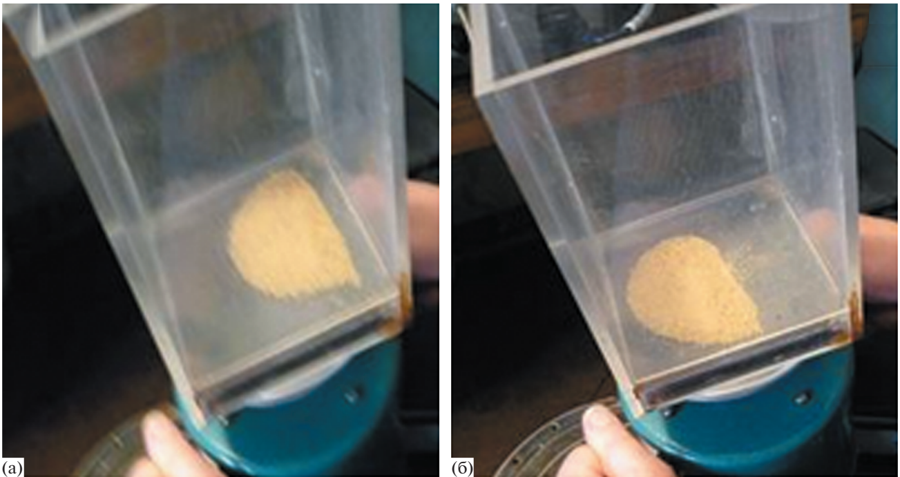
Рис. 7. Свободные без заметного трения передвижения квазиплоского кластера по наклонной вибрирующей плоскости из (а) — исходного положения в (б) — любое конечное положение с практически полным сохранением формы кластера. Условия на параметры вибрации и на углы наклона плоскости, при которых реализуются перемещения кластера практически без трения, обсуждаются в тексте.
