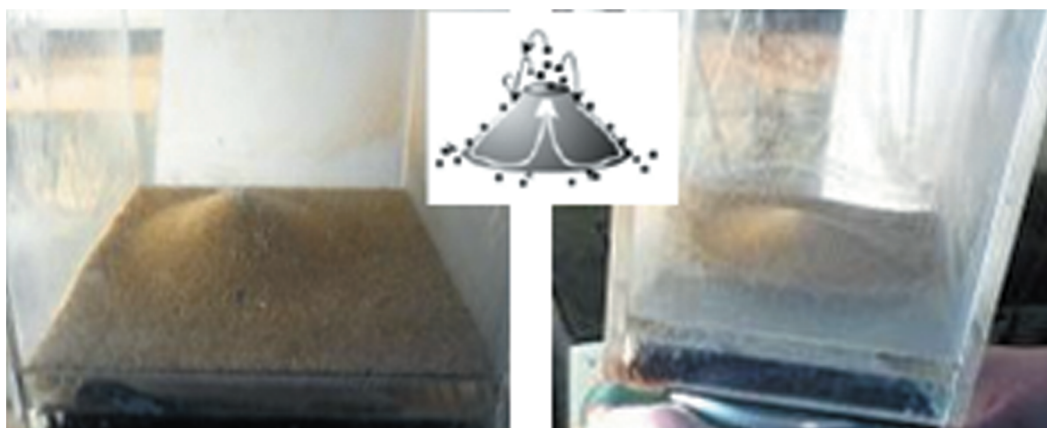
Рис. 10. (а) – Горка песка на вибрирующем вертикально основании с флюидизированной поверхностью. (б) – Движение горки по наклонной вибрирующей поверхности. На врезке – схема циркулирующего движения отдельных частиц и воздуха (светлые стрелки).
