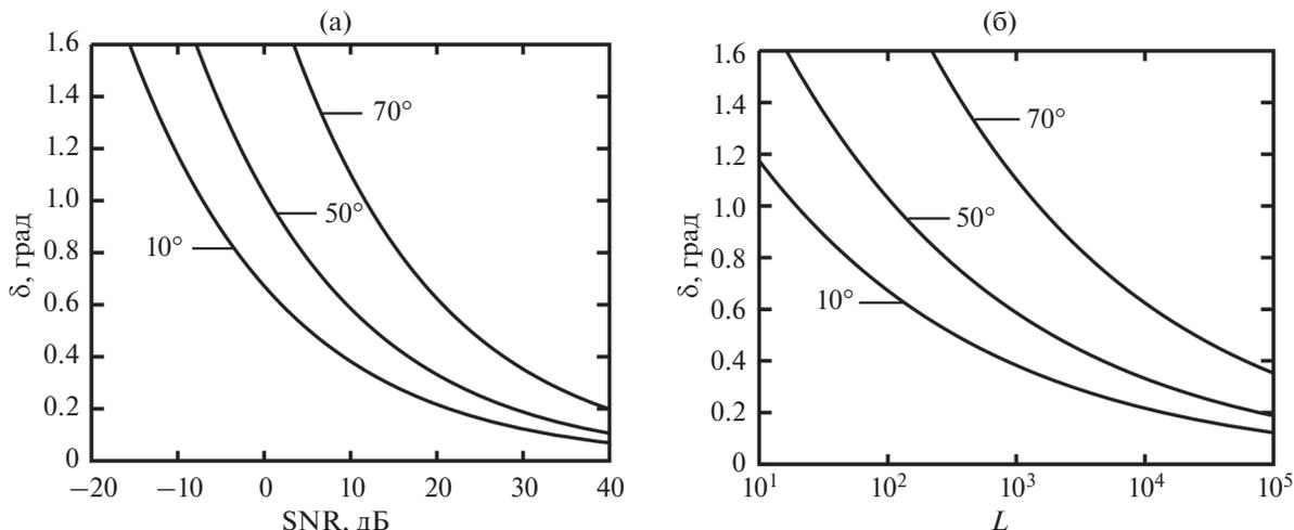
Рис. 5. Зависимость  $\delta$  от входного (а) – SNR и (б) – объема выборки  $L$  для различных угловых положений  $\phi_1$  фиксированного источника.
