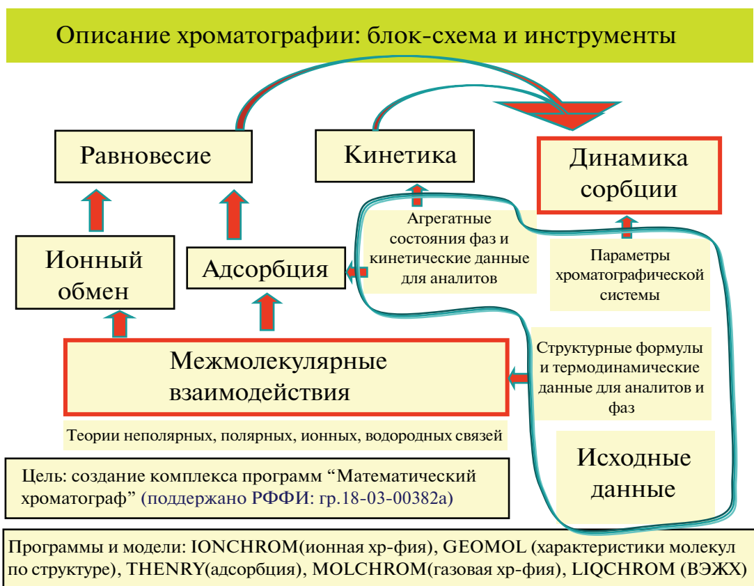
Рис. 1. Блок-схема взаимосвязей в программах по имитационному моделированию методов аналитической хроматографии, входящих в комплекс “Математический хроматограф”.
