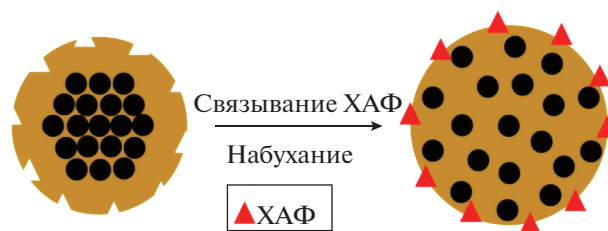
Рис. 8. Схема устройства композиционных частиц, ядро из наночастиц \text{Fe}_3\text{O}_4 и оболочка из сополимера метилметакрилата и акриламида с отпечатанными молекулами хлорамфеникола [123].
