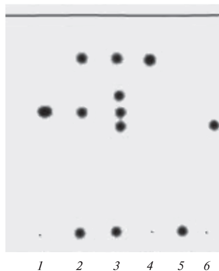
Рис. 5. ТСХ-хроматограмма полимерного комплекса [N\text{-винилпирролидон}]_n\text{-}[N\text{-виниламин}]_m с 1,4- и 6,3-глюкаралактонами: 1 – 6,3-лактон; 2 – образец диализованного полимерного комплекса; 3 – образец 2 после длительного хранения при 23°C; 4 – 1,4-лактон; 5 – полимер-носитель [N\text{-винилпирролидон}]_n\text{-}[N\text{-виниламин}]_m ; 6 – D-глюкаровая кислота. Элюент: n -бутанол–уксусная кислота–вода (2 : 1 : 1), pH 5.5. Детектирование: пары йода. Чувствительность метода – 0.25 мкг.
