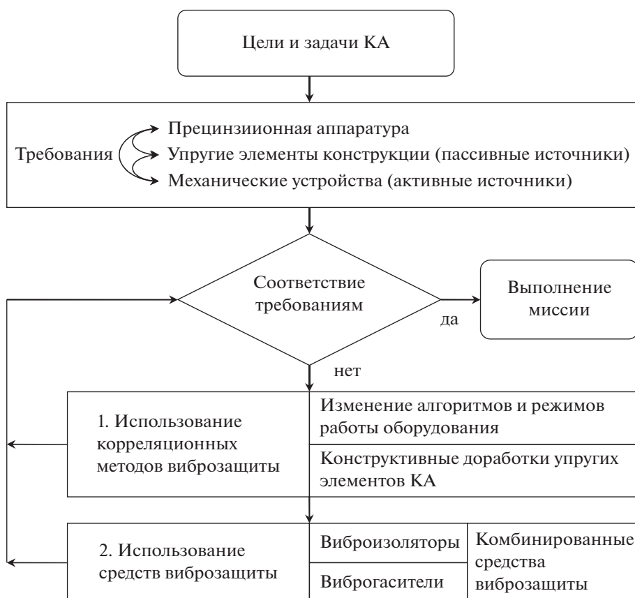
Рис. 1. Блок-схема обеспечения виброзащиты космических конструкций.
