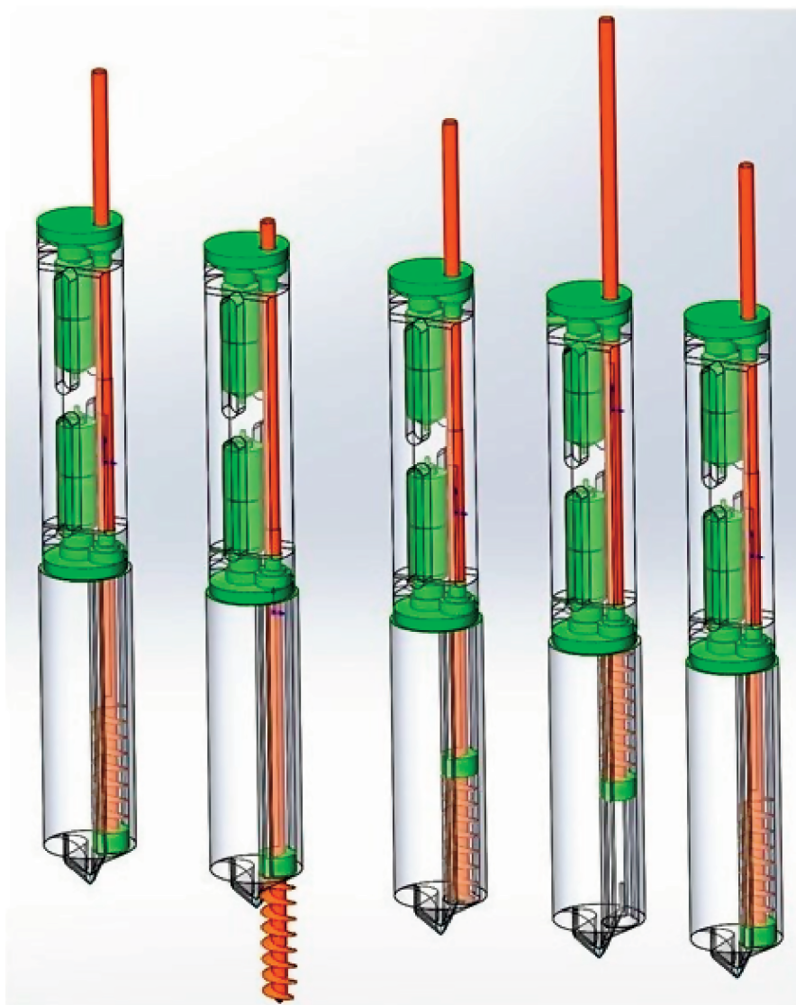
Рис. 11. Схема работы бурового инструмента с шнековым пробоотборником (слева—направо).
