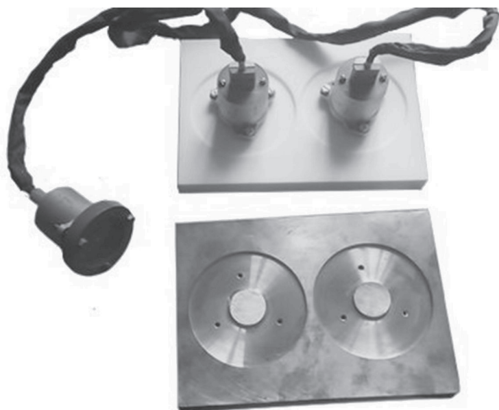
Рис. 16. Фторопластовая (вверху) и медная (внизу) пластины с термодатчиками БПИ для испытаний методами холостого хода и короткого замыкания.
