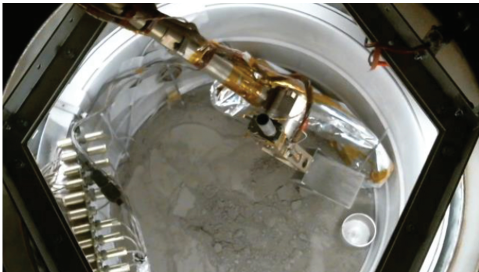
Рис. 13. Установка ТО-1 ЛМК внутри КВС. Вид сверху. Показан ЛМК в раскрытой конфигурации, предназначенной для копания аналога лунного реголита. Также видна поверхность грунта и емкость для выгрузки забранных образцов грунта.
