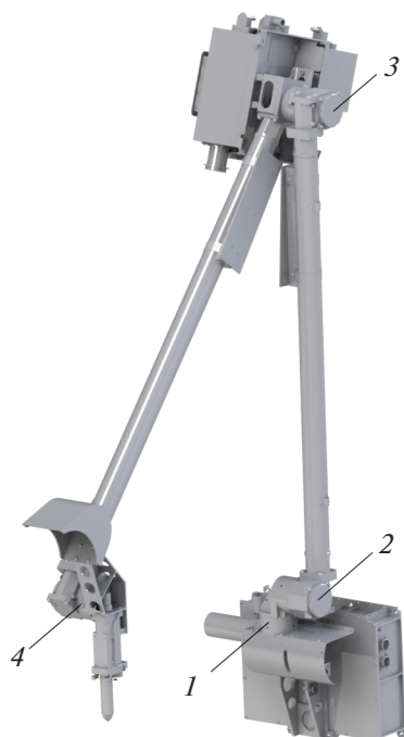
Рис. 2. Трехмерная модель прибора ЛМК. 1 – азимутальный привод; 2 – привод плеча; 3 – привод локтя; 4 – привод запястья.
