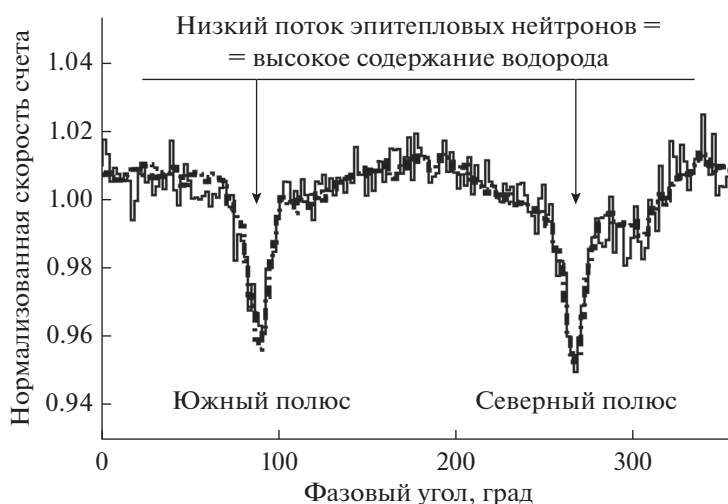
Рис. 3. Вариации потока эпитепловых нейтронов по широте на поверхности Луны, измеренные с прибором LEND (по данным рис. 12 в работе Litvak и др. (2012) с изменениями).
