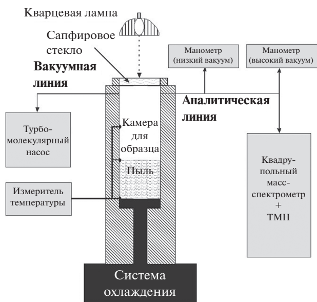
Рис. 5. Схема установки для изучения сублимации льда из марсианского грунта (Mooges и др., 2012).
