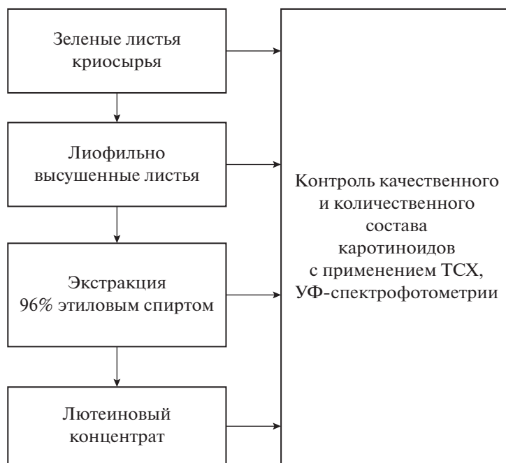
Рис. 3. Схема получения стабильного лютеинового концентрата из зеленого криосырья. Fig. 3. Scheme for obtaining stable lutein concentrate from green cryogenic raw material.
