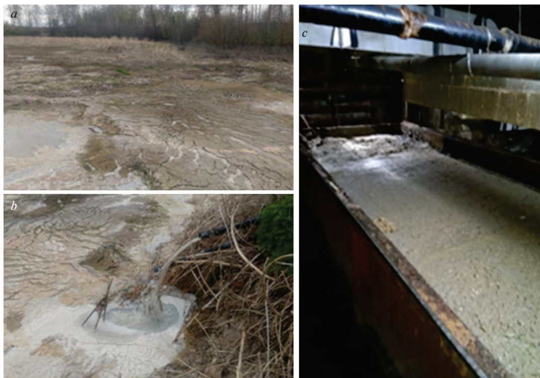
Рис. 1. Места отбора проб. a – пруд-накопитель промышленных отходов с жировыми корками на поверхности, b – место сброса сточных вод в накопительный пруд, c – очистные сооружения, содержащие жидкие стоки с твердыми жировыми корками на поверхности.
