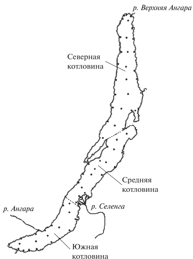
Рис. 1. Карта-схема расположения станций (кружки) по акватории оз. Байкал. Пунктирными линиями обозначены границы котловин.
