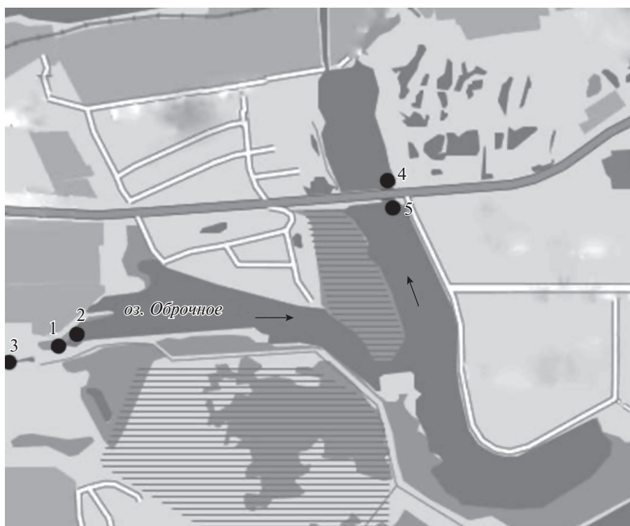
Рис. 1. Схема водоема-охладителя Тюменской ТЭЦ-1. ● — станции отбора проб: 1–3 — зона повышенного подогрева воды (28.0–39.4°C); 4, 5 — зона умеренного подогрева (температура ниже на 4–5°C). Стрелки показывают направление течения.
