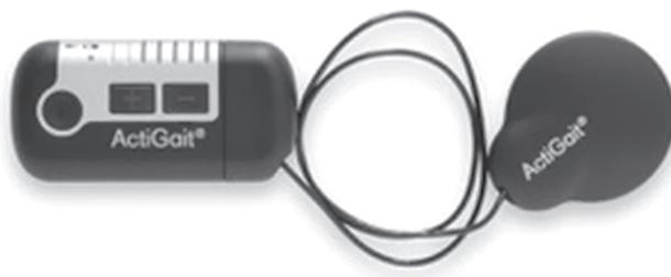
Рис. 3. Электростимулятор с имплантируемыми электродами ActiGait (Дания).
