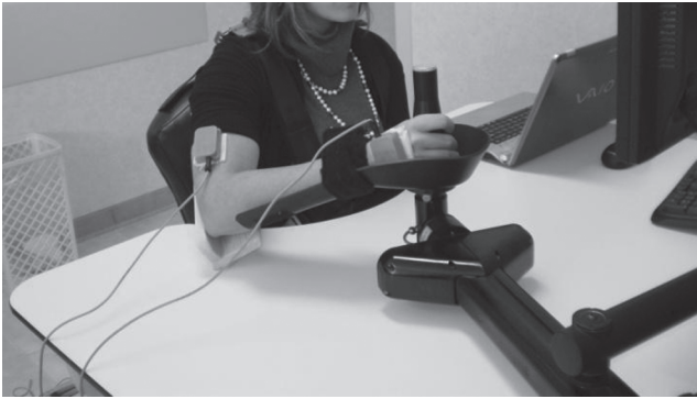
Рис. 2. Роботизированный тренажер MIT-Manus (США), управляемый сигналом пЭМГ.
