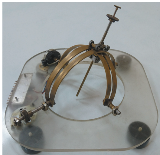
Рис. 2. Механизм с дугообразными звеньями, обеспечивающий постоянство точки ввода.
