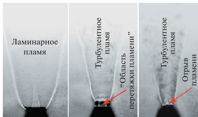
Рис. 2. Теневые картины развития горящей коаксиальной струи водорода (при отсутствии центральной струи воздуха).
