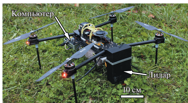
Рис. 2. Общий вид легкого квадрокоптера с установленным флуоресцентным лидаром (справа) и управляющим компьютером (слева).
