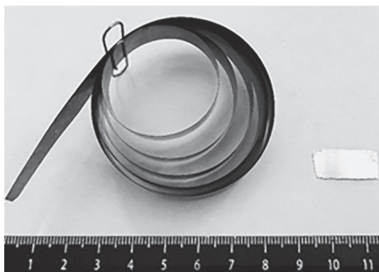
Рис. 1. Макрофотография протяженной ленты из тройного сплава Cu–40%Ni–3%Ta.
