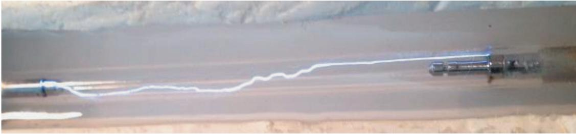
**Рис. 3.** Фотография стримера разряда лампы в воде при ВЧ-накачке (3 МГц) с амплитудой выше порога зажигания последовательностью пачек длительностью 1 мс, следующих с частотой 12 Гц.
