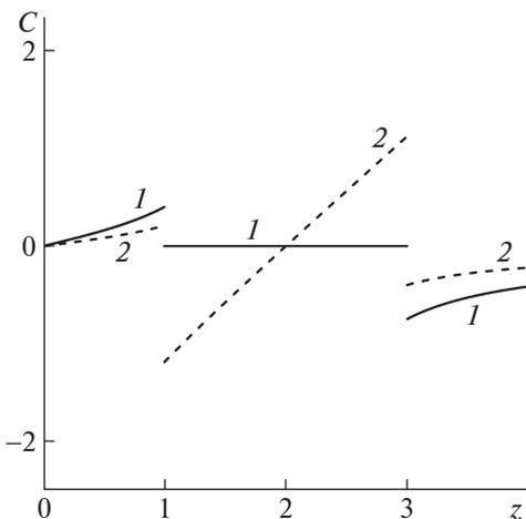
Рис. 4. Распределение возмущений концентрации (1) и надгидростатического давления (2) с глубиной вдоль оси симметрии включения.
