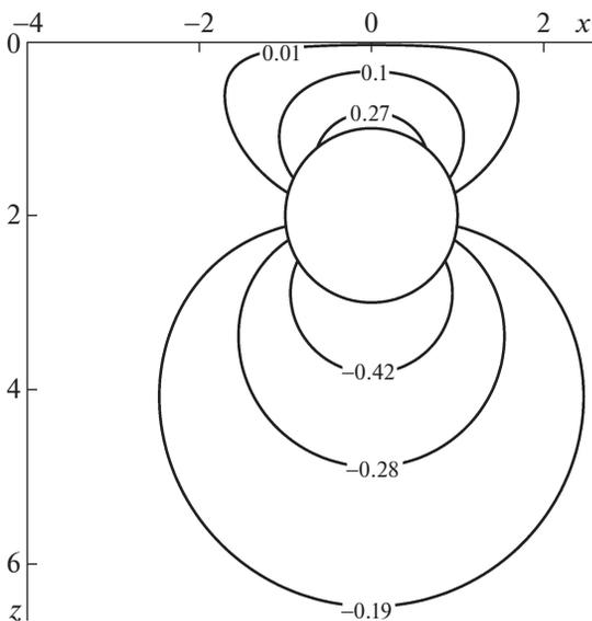
Рис. 3. Линии уровня возмущения поля концентрации соли.
