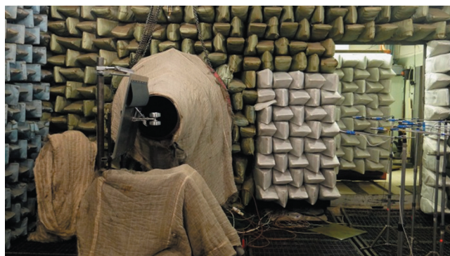
Рис. 1. Фотография заглушенной камеры АК-2 ЦАГИ.
