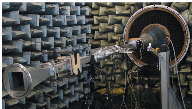
Рис. 4. Установка ЦАГИ “Интерферометр с потоком” в сборке в конфигурации заглушенной камеры АК-2.
