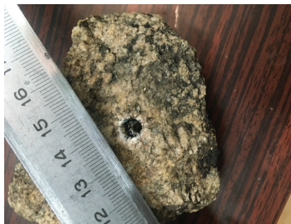
Рис. 50. Зависимость выходной мощности гиротрона от магнитного поля (тока соленоида) при токе электронного пучка и 600 мА и отверстие в куске гранита диаметром около 3 мм, полученное после фокусировки выходного излучения на поверхности образца детализированная.
