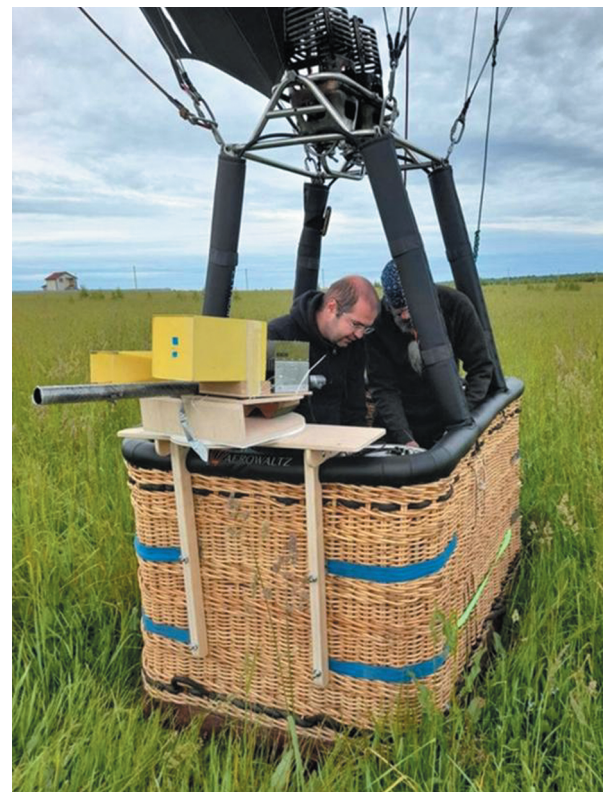
Рис. 3. СШП-излучатели в корзине полетного шара.
