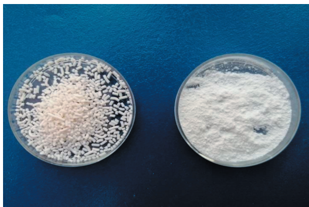
Рис. 1. Изображение гранул и порошка сорбента на основе иванюкита.
