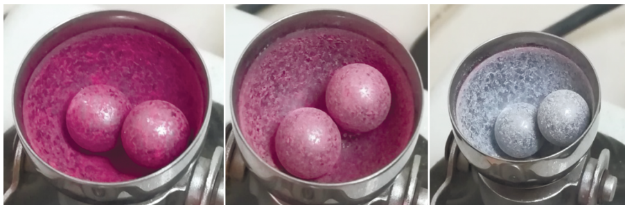
Рис. 6. Изменение окраски 4-фенил-1,2,4-триазаолин-3,5-диона в ходе реакции 6 + 8 \rightarrow 11 (схема 3) в шаровой мельнице после 4, 9 и 14 мин перетирания соответственно [133].
