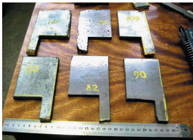
Рис. 1. Образцы из материалов на основе МАХ-фазы Ti_3AlC_2 , полученные СВС-штамповкой.
