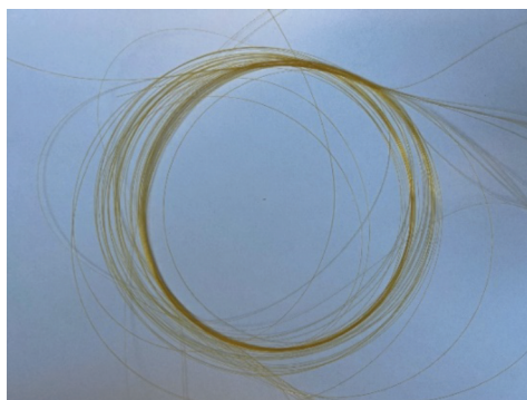
Рис. 3. Кварцевый световод с покрытием из КПИ-4.
