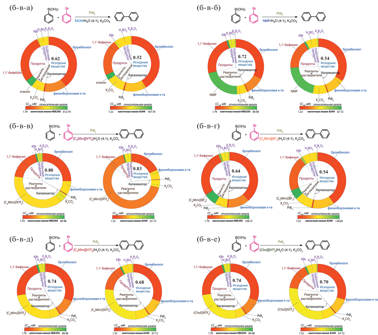
Рис. 7. Биопрофили путей синтеза 1,1'-бифенила при варьировании растворителей. В наименованиях реакций первая буква обозначает исходное вещество бромбензол (б), вторая – катализатор PdI 2 (в), третья – растворитель: этанол (а), NMP (б), [C 2 Mim][NTf 2 ] (в), [C 4 Mim][BF 4 ] (г), [C 4 Mim][NTf 2 ] (д) или [Chol][NTf 2 ] (е).
