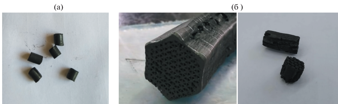
Рис. 1. Сформованные методом экструзии гранулы (а), блок сотовой структуры и фрагменты блока для испытаний (б).
