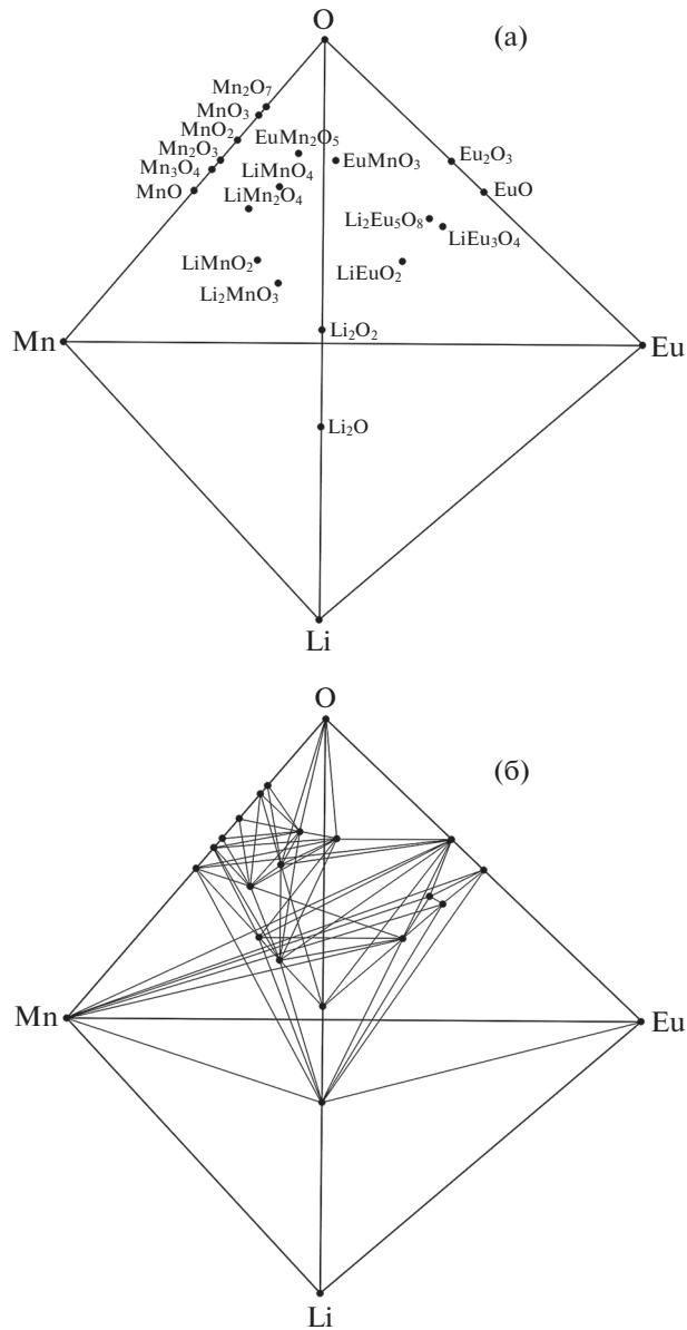
**Рис. 1.** Изотермическая диаграмма субсолидусных фазовых равновесий системы Li–Mn–Eu–O: фигуративные точки оксидов в концентрационном тетраэдре (а), тетрангуляция (б).
