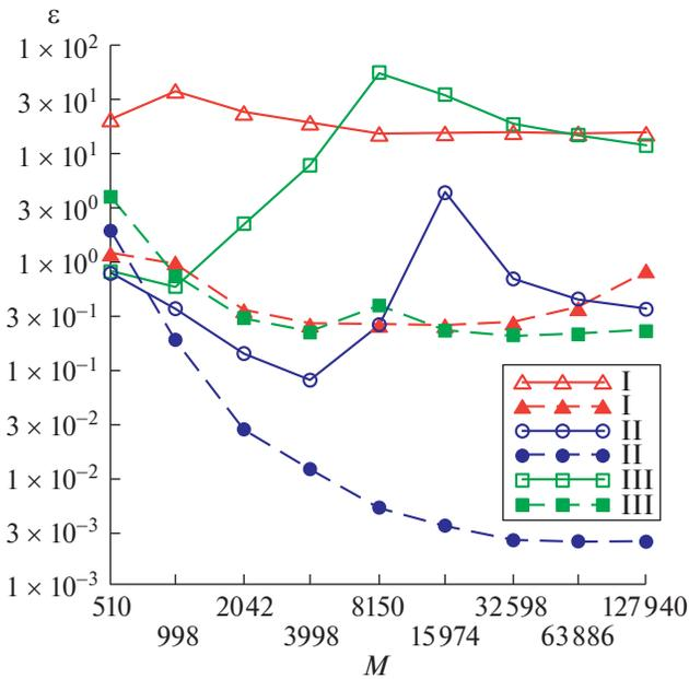
Рис. 1. Погрешности решений задачи дифракции из примера, найденных с использованием уравнения (8) без интерполяции решений.
