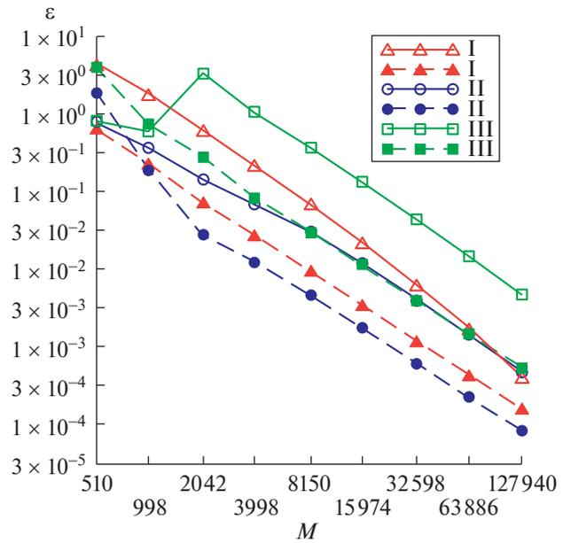
Рис. 2. Погрешности решений задачи дифракции из примера, найденных с использованием уравнения (8) с интерполяцией решений по формулам (13).
