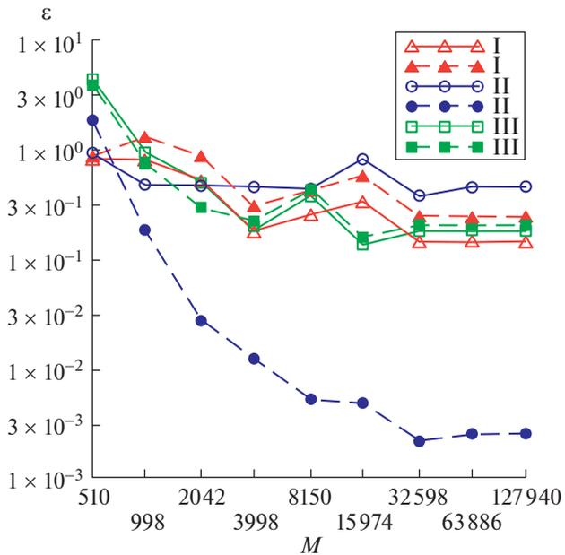
Рис. 3. Погрешности решений задачи дифракции из примера, найденных с использованием уравнения (10) без интерполяции решений.
