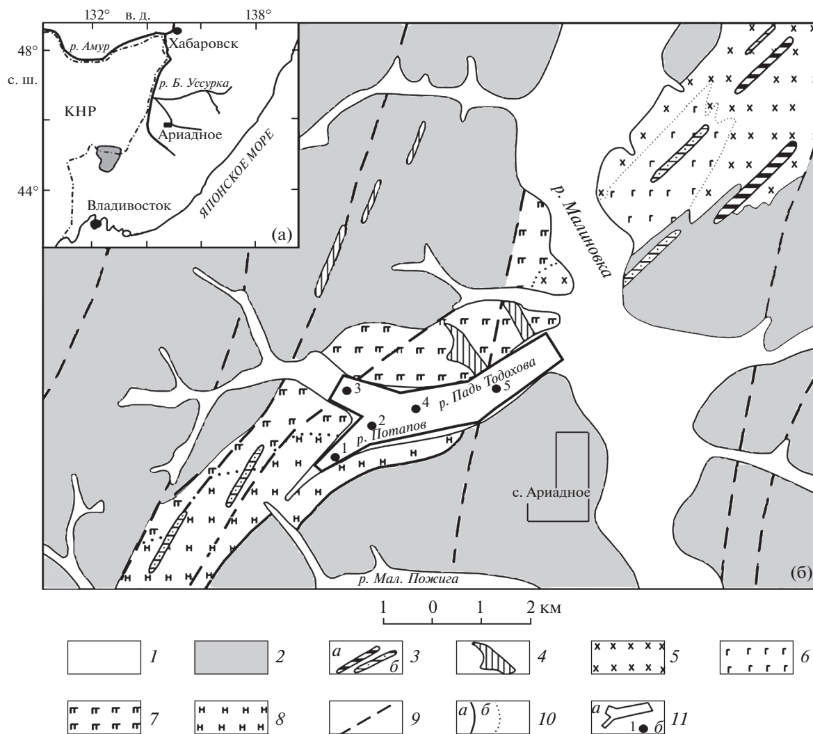
Рис. 1. Схема геологического строения Ариадненского рудно-россыпного узла. Составлена авторами с использованием материалов В.М. Лосива (1990) и И.В. Кемкина с соавторами [11]. А – местоположение изученной площади; Б : 1 – четвертичные аллювиальные отложения; 2 – верхнеюрские турбидиты и олистостромы аккреционной призмы с включениями позднепалеозойских и нижнемезозойских океанических кремней, сланцев, известняков и базальтов; 3 – дайки основного ( а ) и кислого ( б ) состава ( K_2 ); 4 – диориты, кварцевые диориты, гранодиориты ( K_2 ); 5–8 – породы Ариадненского массива ( K_1 ); 5 – диориты, монцедиориты и сиениты; 6 – габбро; 7 – ильменитовые габбро со шликерами перидотитов; 8 – перидотиты; 9 – разрывные нарушения; 10 – границы разновозрастных стратиграфических и интрузивных образований: достоверные ( а ), фациальные ( б ); 11 – ильменитовые россыпи ( а ), точки отбора проб ( б ).
