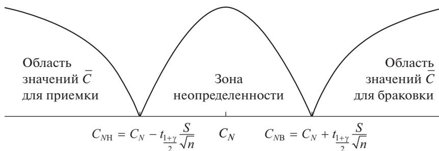
Рис. 2. Шкала значений норматива, где областью приемки является зона соответствия показателя качества нормативу, а областью браковки – зона несоответствия.
