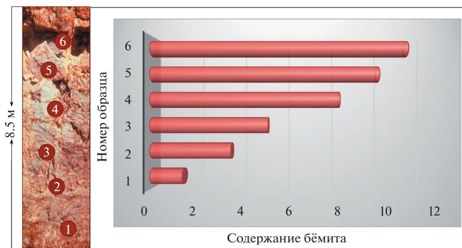
Рис. 1. Образование фазы бёмита при термическом разложении гиббсита.
