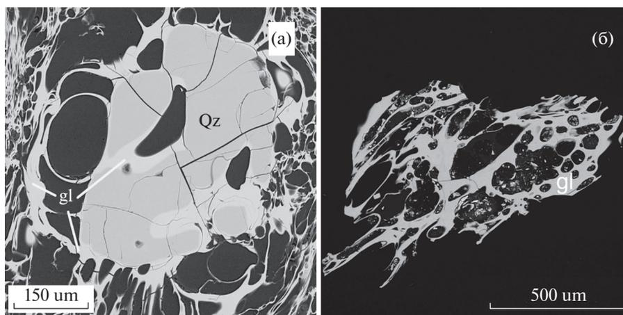
**Рис. 5.** Пузыристое строение стекла основной массы вокруг вкрапленника кварца пемзы из разреза Гурам (а) и стекловатой пепловой частицы из торфяника на о. Уруп (б, обр. 11/3709). Изображения получены на сканирующем электронном микроскопе “TESCAN” MIRA 3LMU в режиме обратно-рассеянных электронов (BSE).
