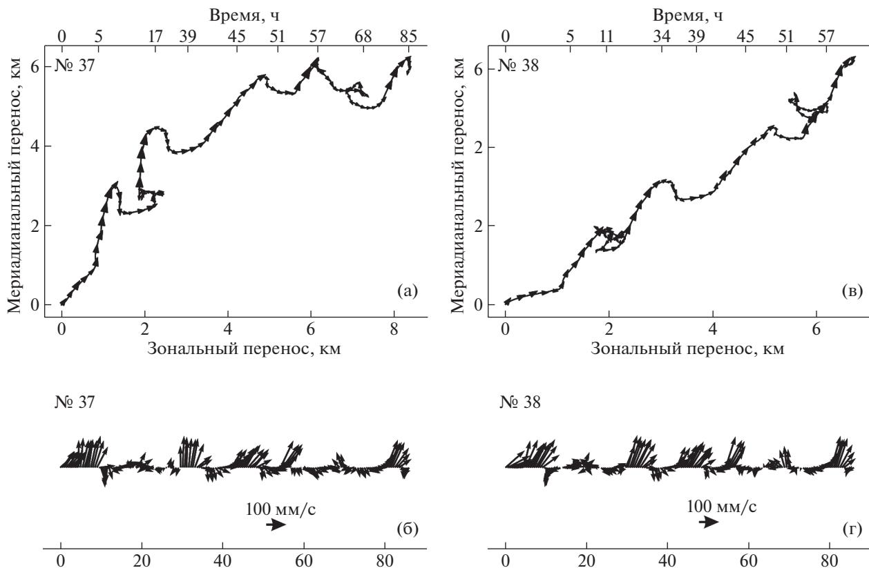
**Рис. 3.** Придонный перенос водных масс на ст. 7442А по данным инклинометров № 37 и № 38: (а, в) – прогрессивно-векторные диаграммы течений; (б, г) – изменчивость скорости и направления течения во времени (стрелки показывают географическое направление течения, длина стрелки – модуль скорости).
