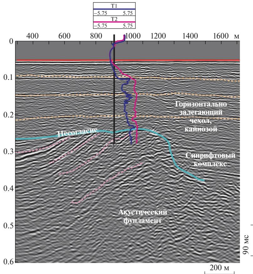
Рис. 4. 1 Интерпретация данных DTS-термометрии. Фиолетовая кривая – температурный профиль сразу после бурения; синяя кривая – температурный профиль через пять суток.
