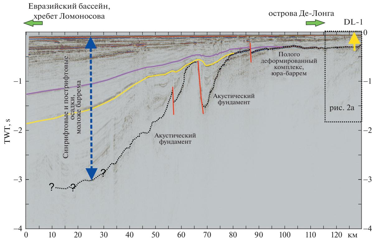
**Рис. 7.** Сейсмический профиль МОВ ОГТ DL11-01 и его интерпретация с учетом данных бурения скважины DL-1. Очевидно, что полого залегающий осадочный чехол, включая синрифтовые отложения, моложе возраста деформированных осадков, вскрытых скважиной. Акустический фундамент может быть сложен как породами юры-неокома, так и более древними комплексами.
