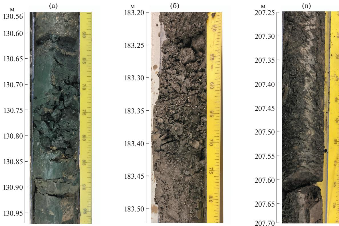
**Рис. 5.** Фотографии фрагментов керна, вскрытых скважиной DL-1. а – фрагмент керна с глубины ~130 м (рыхлые отложения кайнозоя), б – несортированные терригенные отложения верхней части нижней (меловой) толщи (~183 м), в – дислоцированные нижнемеловые аргиллиты (~ 207 м). Глубина залегания в метрах от поверхности дна.
