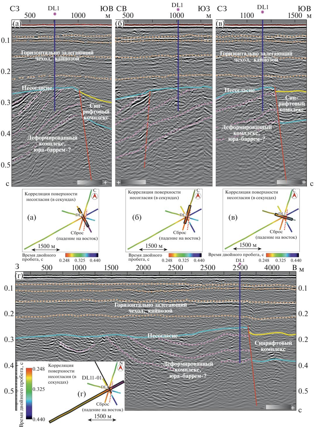
**Рис. 3.** Сейсмоакустические профили, проходящие через точку бурения скважины DL-1 и их интерпретация (профиль а показан на рис. 2 б). На картограммах отражено расположение фрагментов профилей (черные прямоугольники), время двойного пробега в секундах для поверхности основного несогласия (цветовой градиент), линия сброса (красный пунктир). К востоку от разлома видна недеформированная толща, не вскрытая скважиной. Предполагается, что это часть синрифтового комплекса.
