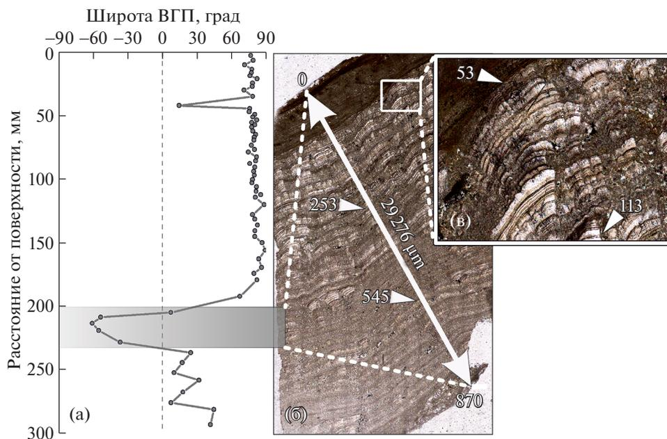
**Рис. 2.** (а) Кривая изменения широты виртуального геомагнитного полюса в зависимости от глубины по данным керна Vor15. Затененной серой областью показан интервал, соответствующий образцам 53–57 и изученный методом приростной хронологии; (б) микроизображение шлифа фрагмента керна Vor15, содержащего  $871 \pm 16$  пар слоев; (в) участок того же шлифа в более крупном масштабе, демонстрирующий слой годичного прироста спелеотема.
