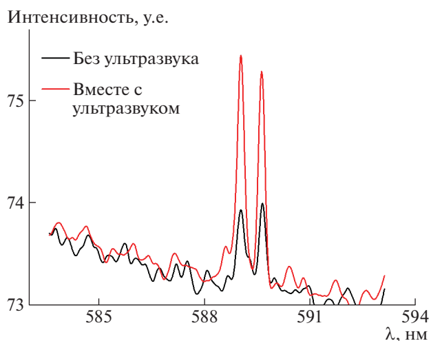
Рис. 2. Интенсивность линий натрия с использованием и без использования ультразвука при 3.5% концентрации раствора NaCl.
