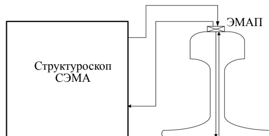
Рис. 1. Схема установки электромагнитно-акустического преобразователя (ЭМАП) на головке рельса и ход лучей.
